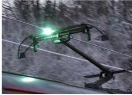
شکل ۱-۳- قوس الکتریکی در میان شبکه بالاسری و پانتوگراف
