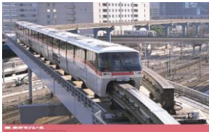
شکل ۱- سیستم مونوریل در حالت استرادل
