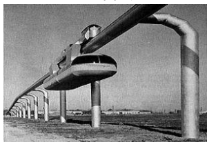
شکل ۲- سیستم مونوریل در حالت آویز
